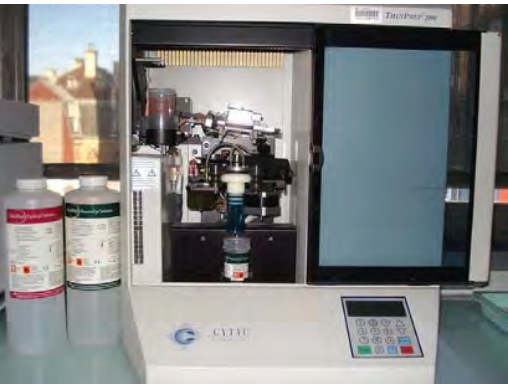
Fig. 3-56 Préparateur automatique à chargement individuel ThinPrep® 2000 (Cytoc).
